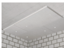
Reststuk eerste rij gebruiken als eerste stuk van tweede rij; naden min. 20 cm laten verspringen.
