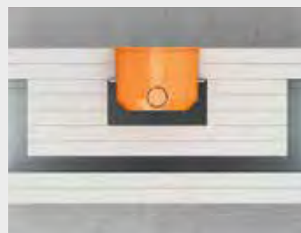
Bij wanden zonder isolatiemateriaal - de wandcontact-, schakel-, en verdeeldozen volledig omsluiten met fermacell Gipsvezelplaten met een gelijke dikte als de beplating van de wand.
