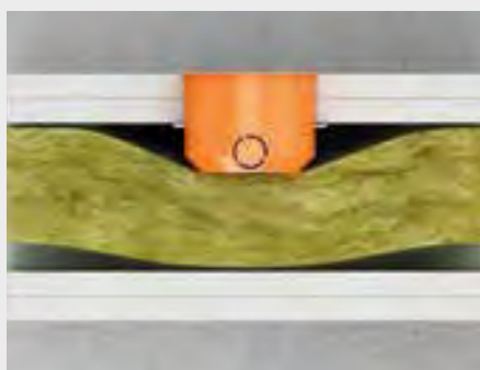
Bij wanden met isolatiemateriaal - ter plaatse van de wandcontactdozen moet de samengedrukte isolatie minimaal 30mm zijn.
