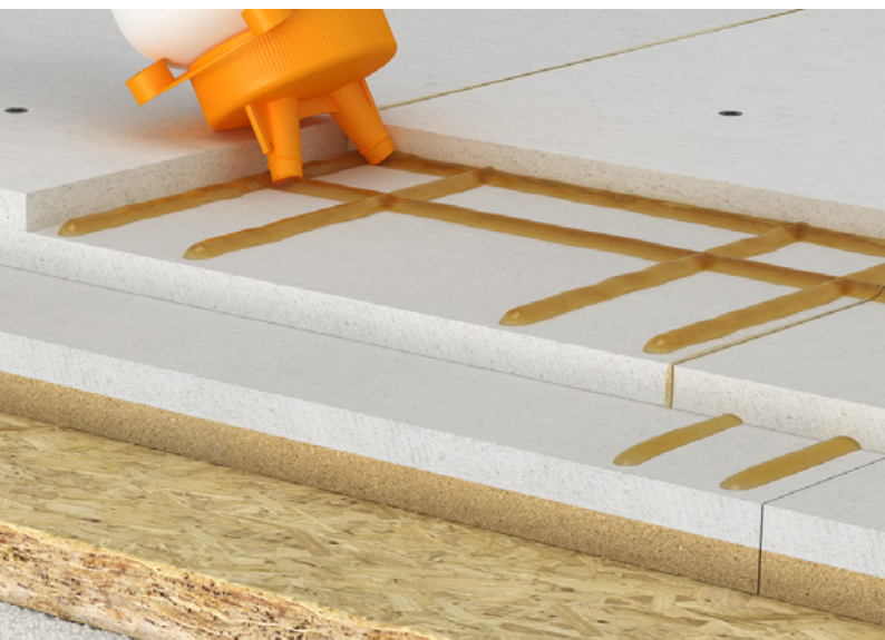
Bande de colle sur le bord de la plaque avec un écart de 100 mm entre les axes.
