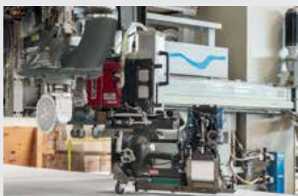
Afbeelding 2: Machinale bevestiging met industriële nagel- en nietinstallaties
