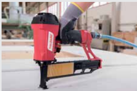
Afbeelding 1: Manuele bevestiging met pneumatische tackler
