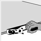
Afbeelding 4: Afwerken van het breukvlak d.m.v. schaven
