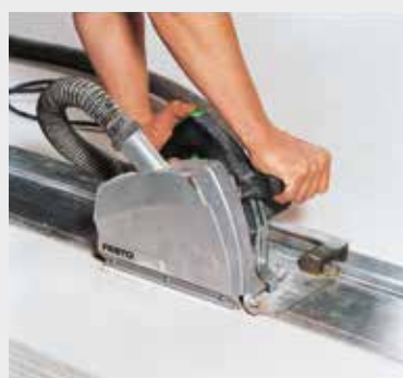
Afbeelding 3.2: Handcirkelzaag met geleidingsrail
