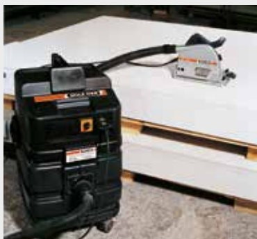
Afbeelding 3.3: Handcirkelzaag met stofafzuiging
