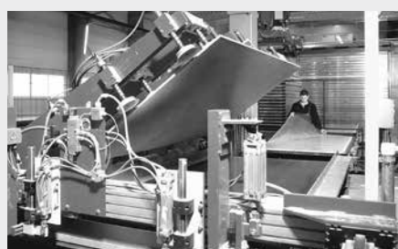
Afbeelding 1.3 : Volautomatisch uit de mal nemen van de platen
