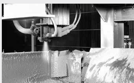
Afbeelding 1.2 : Aanbrengen van de plaatlaag aan de malzijde
