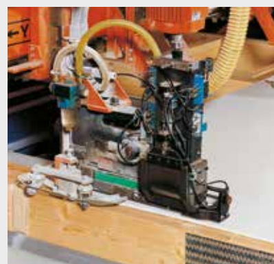
Afbeelding 3.10: Machinale bevestiging met industriële nietmachine
