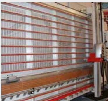
Afbeelding 3.1: Platen op maat zagen met een platenzaag
